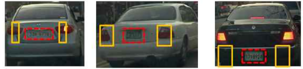
그림 2. aspect ratio에 따른 context_{plate} 영역 설정
