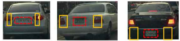
그림 2. aspect ratio에 따른 context_{plate} 영역 설정
